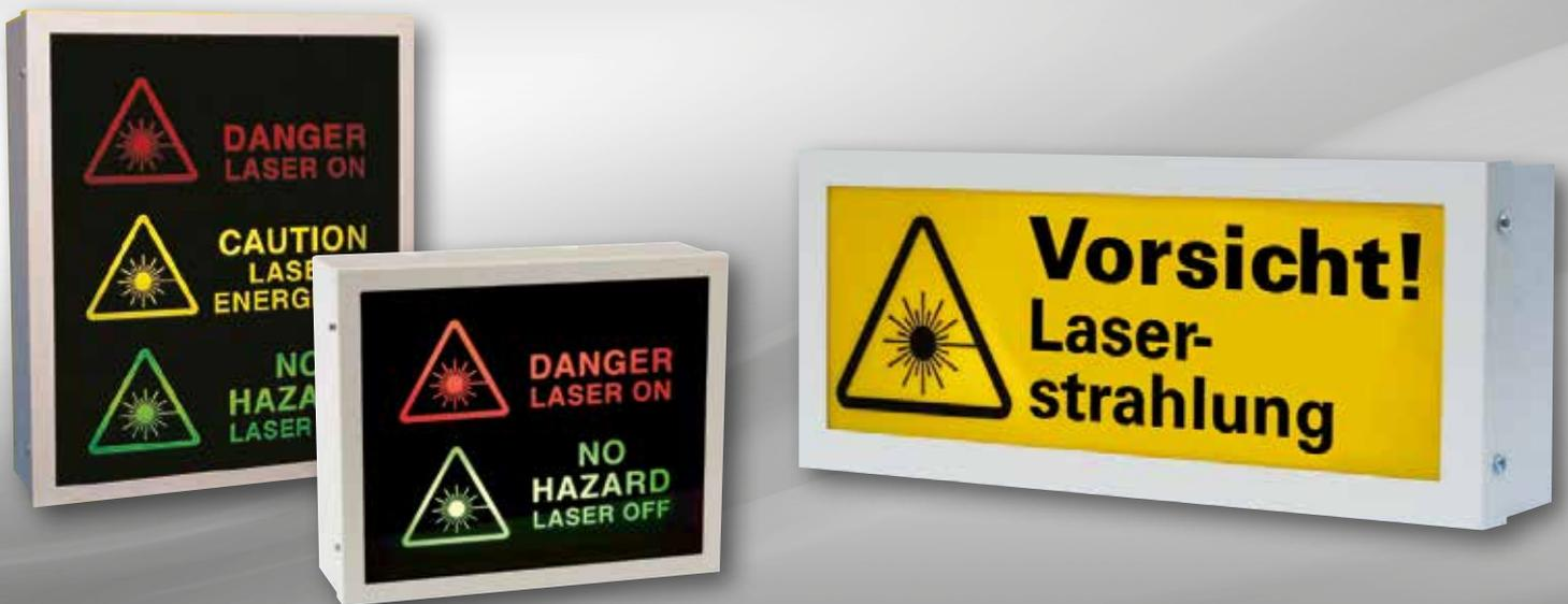
Diese Warnleuchten sind mit einer Einfach-/Zweifach- und Dreifach-Anzeige lieferbar. Die Leuchtanzeigen sind mit 8 W Energiesparlampen ausgestattet. Bei Mehrfachanzeigen verfügt jedes Segment über zwei Lampen und hat somit bei Ausfall einer Lampe entsprechende Redundanz. Das Anzeigengehäuse aus Stahlblech ist cremefarbig pulverbeschichtet und hat eine Acrylglas-Frontscheibe.
