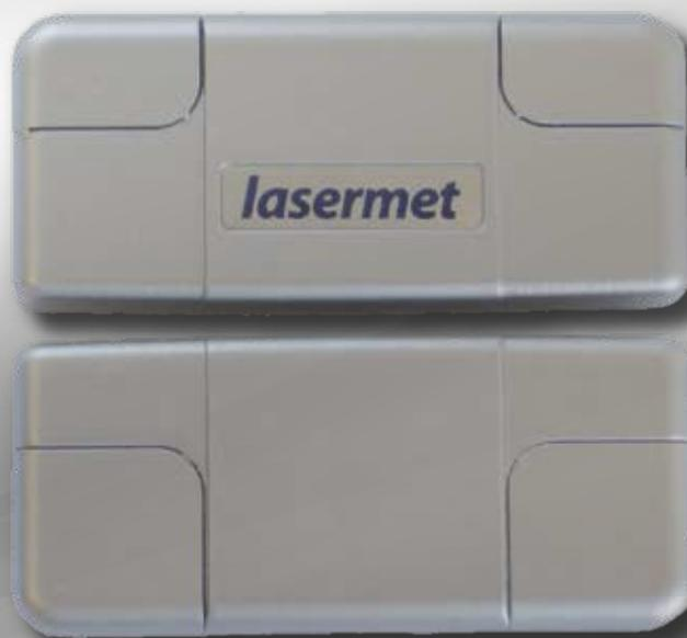
Der Interlock-Schalter IS-MDC-12 ist ein zweikanaliger codierter magnetischer Türschalter. Dieser überwacht den Zustand einer Tür oder einer Klappe von einem Laserbereich. In Verbindung mit einem Interlock-Kontrollsystem, stellt dieses Produkt einen wesentlichen Teil der Sicherheitskette dar.
